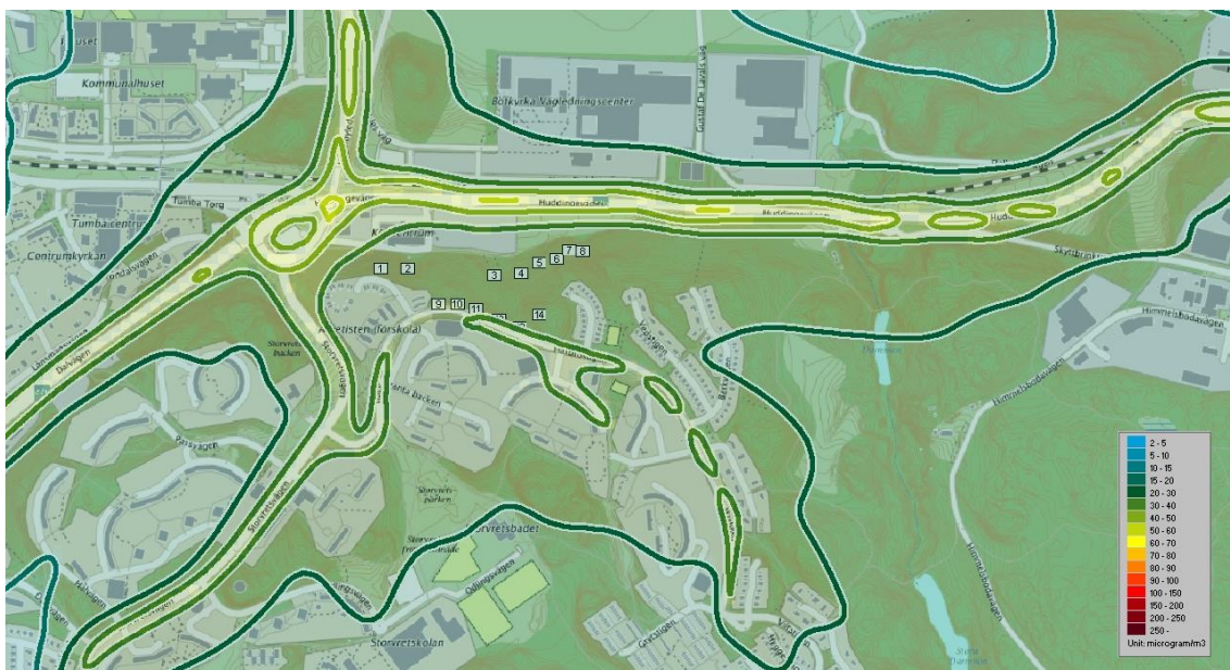
Figur 7. Totalhalter för det utbyggda planförslaget 2040, NO 2 98-percentil dygn. Siffrorna 1-14 representerar receptorpunkter vid tillkommande bostadsbebyggelse enligt detaljplaneförslaget.
