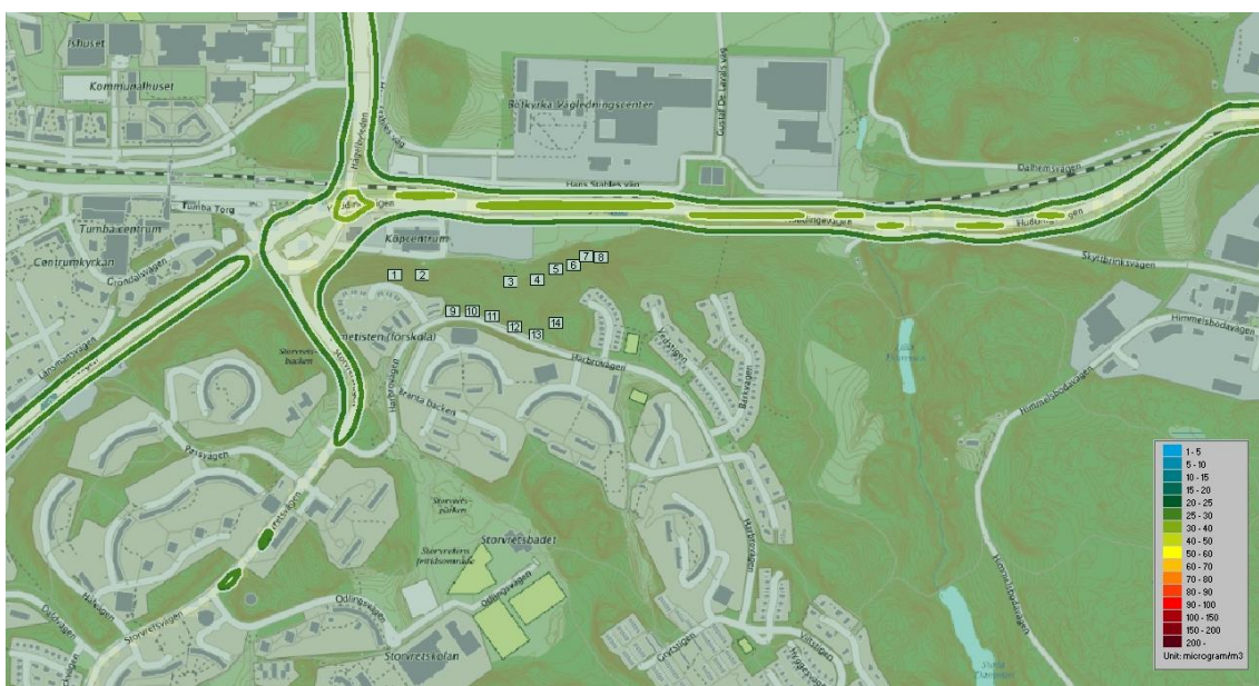
Figur 9. Totalhalter för det utbyggda planförslaget 2040, PM10 98-percentil dygn. Siffrorna 1-14 representerar receptorpunkter vid tillkommande bostadsbebyggelse enligt detaljplaneförslaget.
