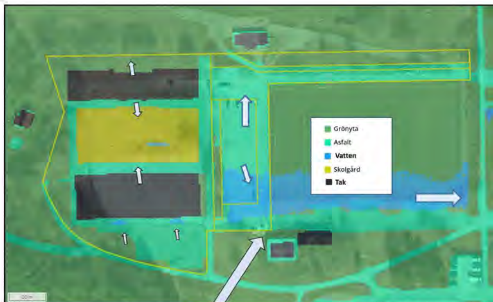
Figur 7-1: Skyfallsanalys för planerad situation. Figuren redovisar vattensamlingar vid 100-årsregn, motsvarande 50 mm regn. Vattendjup större än 10 cm visas i blå. Huvudsaklig avrinningsriktning visas med ljusblå pilar.
