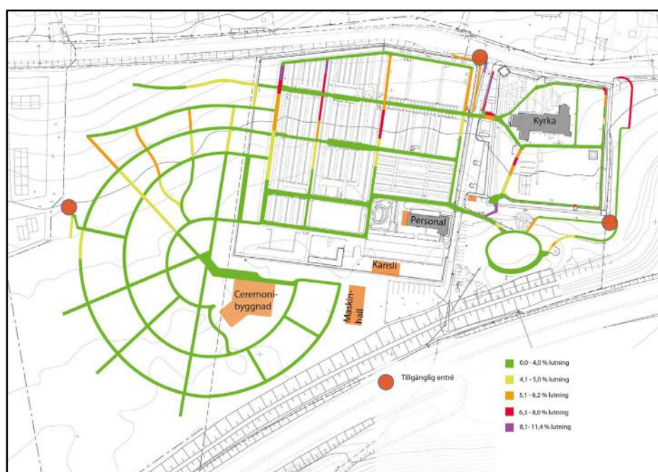
Illustrationsdiagram över tillgängliga passager inom kyrkogårdsområdet (befintliga och utvidgade delar). Mörk- och ljusgröna passager motsvarar lutningar mellan 0-5 %. Utdrag från Gestaltungsprogram (Bjering 2020-10-14)
