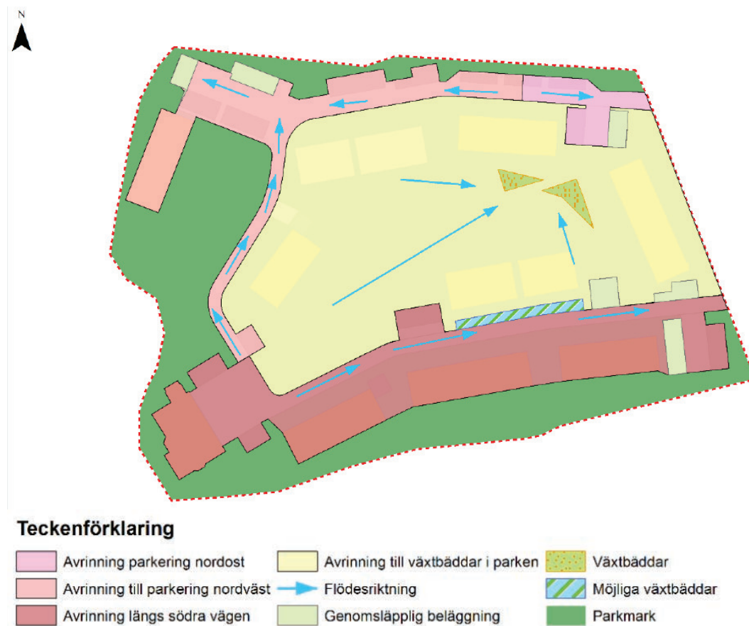
Bild 7. Illustration över dagvattenlösning/växtbäddar (Geosigma).
